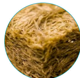
aislamiento con lana de roca en HAUT BLAST PLUS
