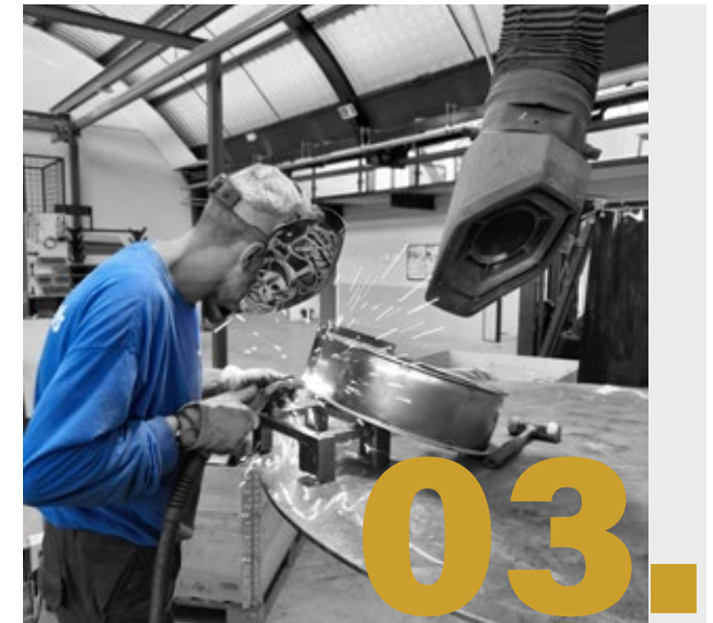
NIMUS. Proceso de soldadura con extracción de gases localizada.
