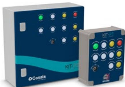
✓ Permite controlar **dos compuertas** de regulación motorizadas y un **ventilador para cada compuerta** que funcionan **por separado**. En el caso de detectarse humo, la compuerta que lo detecte se cerrará y hará que se pare el ventilador para que no entre el humo. Mientras tanto, el otro ventilador seguirá presurizando siempre y cuando su compuerta no detecte señal de humo.
