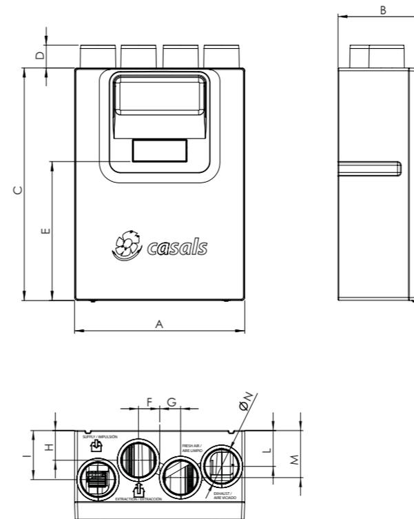
◦ Recuperador de calor para casas de una superficie de hasta 180 m<sup>2</sup>.
