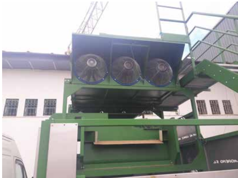
Ventilador instalado en máquina agrícola (aceitunas) HB (con turbina de poliamida)
