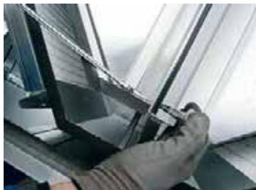
Desenrosque la tuerca y el perno de la cuchilla de derivación en correspondencia con el pasador para el ajuste externo.
