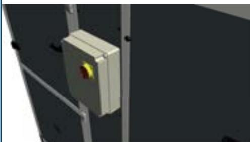
2 - Afloje los dispositivos del panel de bloques y gírelos
